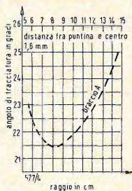
Fig. 2 - Angolo di tracciatura per il braccio A della fig. 1. Con un angolo fra l'asse del braccio e l'asse della capsula di 23,1° si ha un errore di tracciatura sempre inferiore a 2° ed un errore nullo nei solchi centrali.
