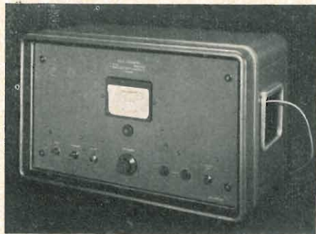
Il nuovo generatore di rumore MARCONI Tipo TF1301 è costruito per misurare fattori di rumore compresi fra i 0 a 20 dB in impianti di comunicazione funzionanti sulla banda da 200 a 1700 Hz. La potenza del rumore all'uscita di un impianto in esame viene riportata su di un indicatore esterno con un rivelatore quadratico. Variazioni di frequenza, tensione di rete e temperatura ambiente non provocano variazioni della potenza d'uscita del rumore superiori ai \pm 0,2 dB.
