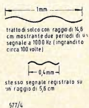
Fig. 4 - Confronto fra lo stesso segnale (2 periodi a 1000 Hz) registrato in diversi solchi.
